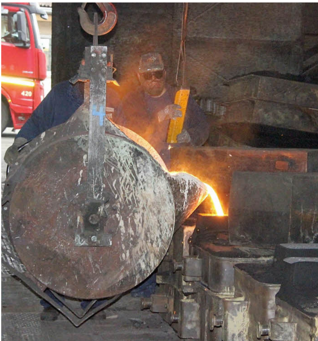
Fast 1400 Grad heißes Gusseisen läuft aus dem Behälter in die Formen.
