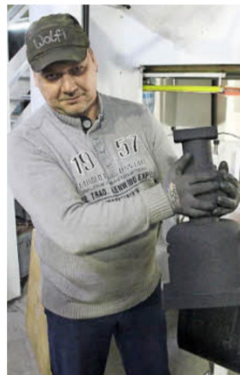
Ein gepresster Sandkern wird aus der Kernschießmaschine entnommen.
